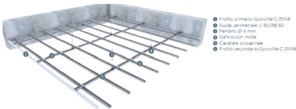
Figura 17 - Schema di montaggio
